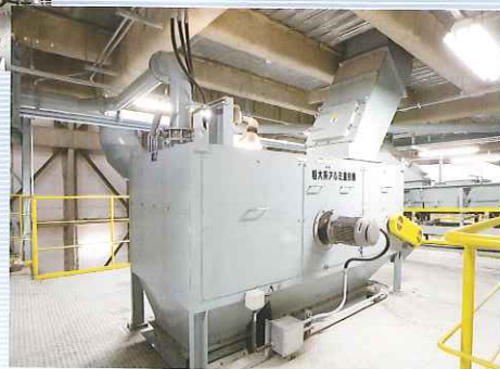
4 アルミ選別機 高速回転する永久磁石により発生する「うず電流」と「反発力」を利用して、可燃物からアルミを選別しています。
