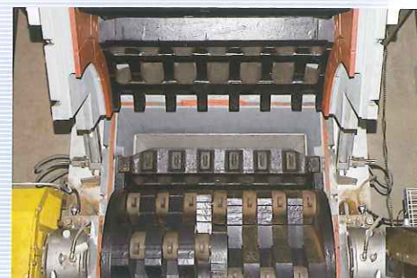
2 不燃性粗大ごみ破砕機 ハンマーが高速で回転しています。不燃性粗大ごみをハンマーで叩いて細かくしています。
