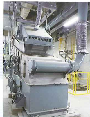
3 磁力選別機 磁力選別機に内蔵した電磁石により、破砕機で細かくしたごみの中に含まれている鉄類を選別しています。
