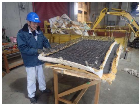
写真17 スプリング取り外し
