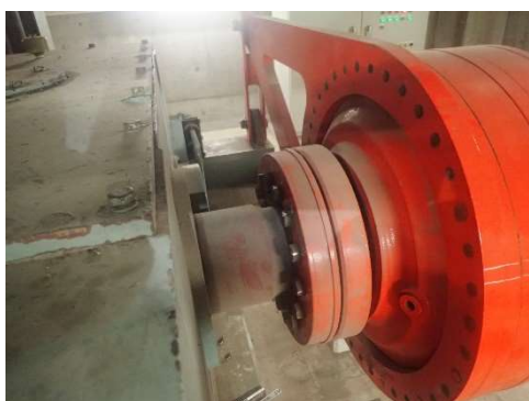
写真7 カップリング点検
