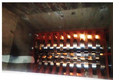
写真 4 破碎機下部から見た切断
