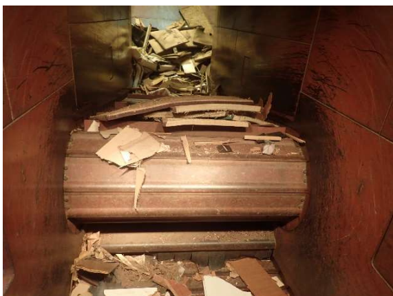
写真 11 可燃性粗大ごみ投入コンベヤ
